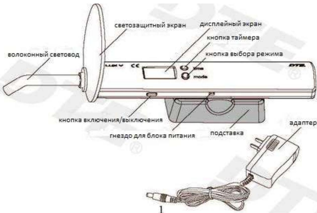
«LUX V» (стоматологический) состоит, главным образом, из мощного светодиода, волоконного световода, блока управления и блока питания.
